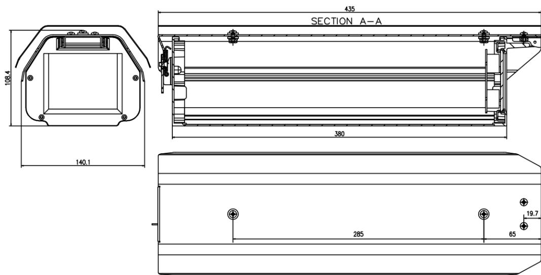
15 寸机壳带遮阳罩尺寸参考图
