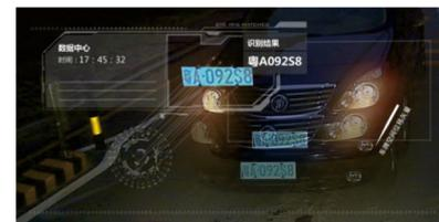
车辆3D建模搭配高精度车牌识别算法，不仅能够精准识别车牌数据及车辆三维立体信息，而且通过对场景深度信息的挖掘，获取车辆空间位移矢量，实现100%车辆（含无牌车）视频触发，彻底杜绝漏识别。
